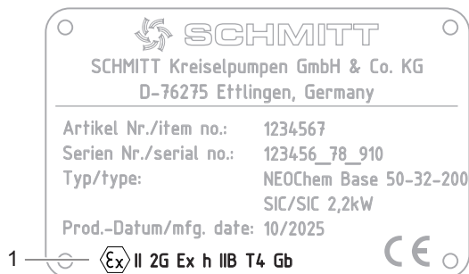
Abb. 2 Typenschild ATEX (Beispiel)
